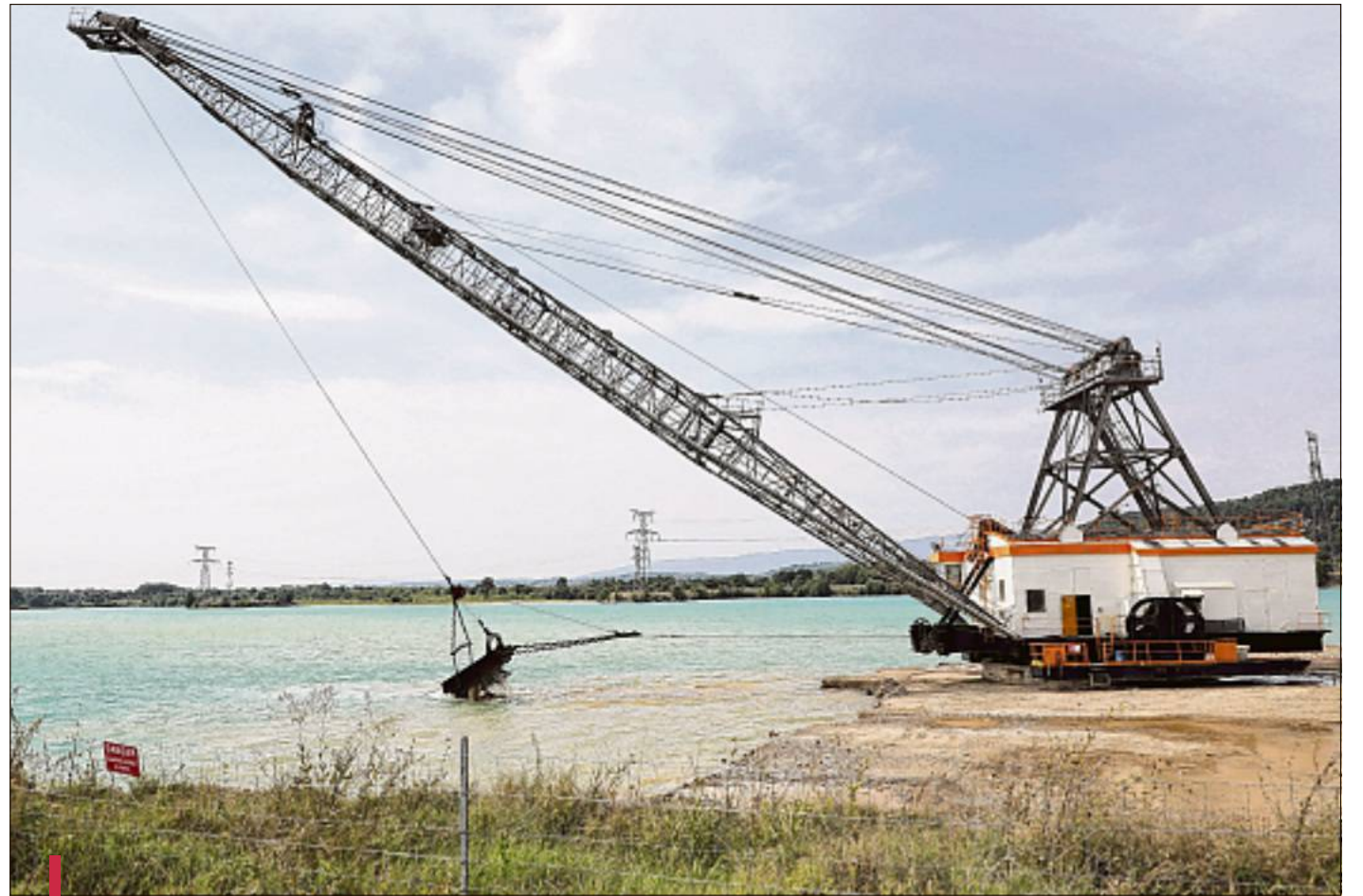
Chloée, la dragline installée sur le bord de l'étang des Chapeliers à Peyrolles, témoin de la récente exploitation du site pour ses graviers. Ce matériel a connu son heure de gloire dans les années 70 permettant une extraction en profondeur. /PHOTO GILLES BADER
