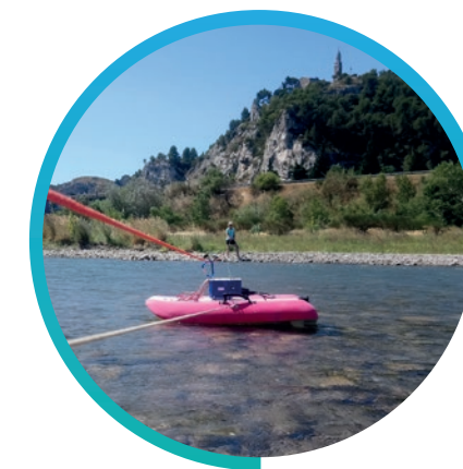
L'ADCP ou la mesure des débits
