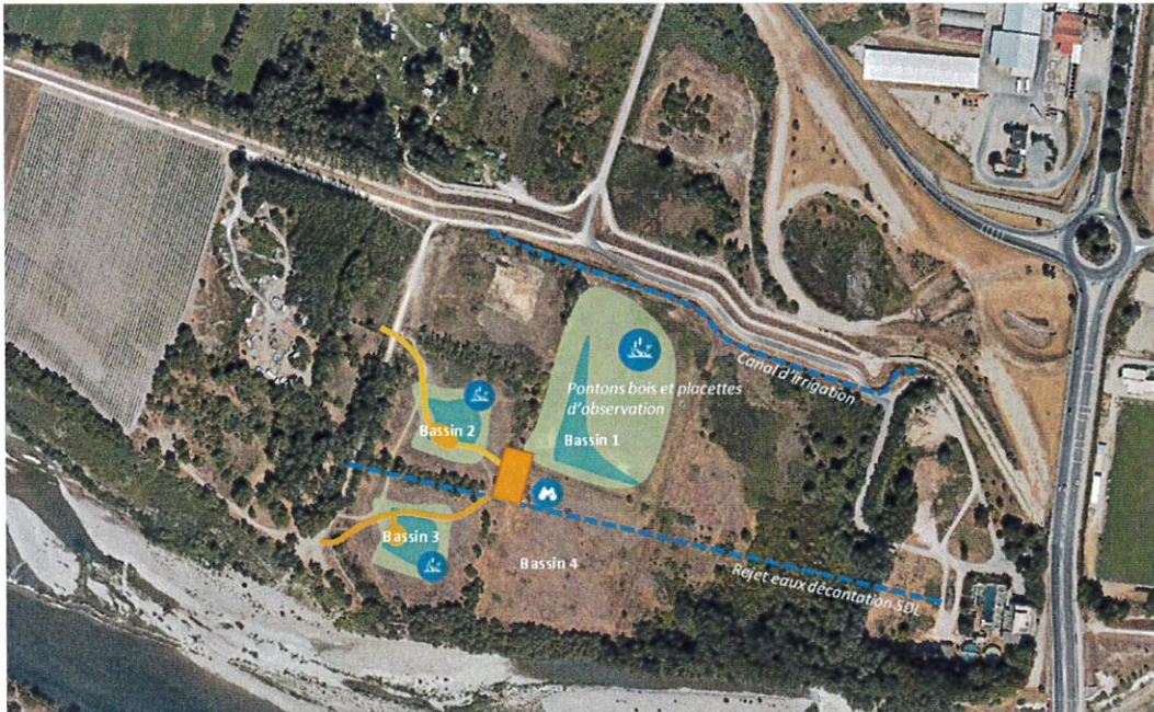
Schéma de principe de réhabilitation de la zone humide de Tarteau : création de zones ennoyées peu profondes (en jaune) et de zones plus profondes (en vert). Aménagements connexes : mise en place d'un cheminement piéton et d'une plateforme d'observation
